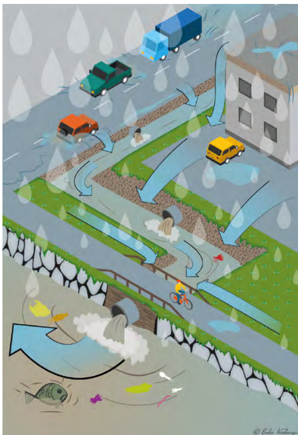
Exempel på ett konventionell sätt att ta hand om dagvatten.
