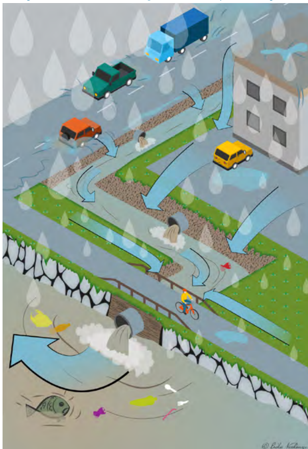
Esimerkki perinteisestä hulevesien hallinnasta
